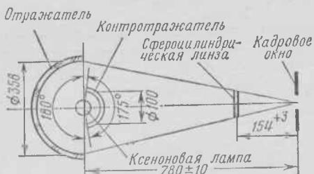
Рис. III.5. Схема осветителя со сфероцилиндрической линзой двухформатного 70/35-мм кинопроектора
